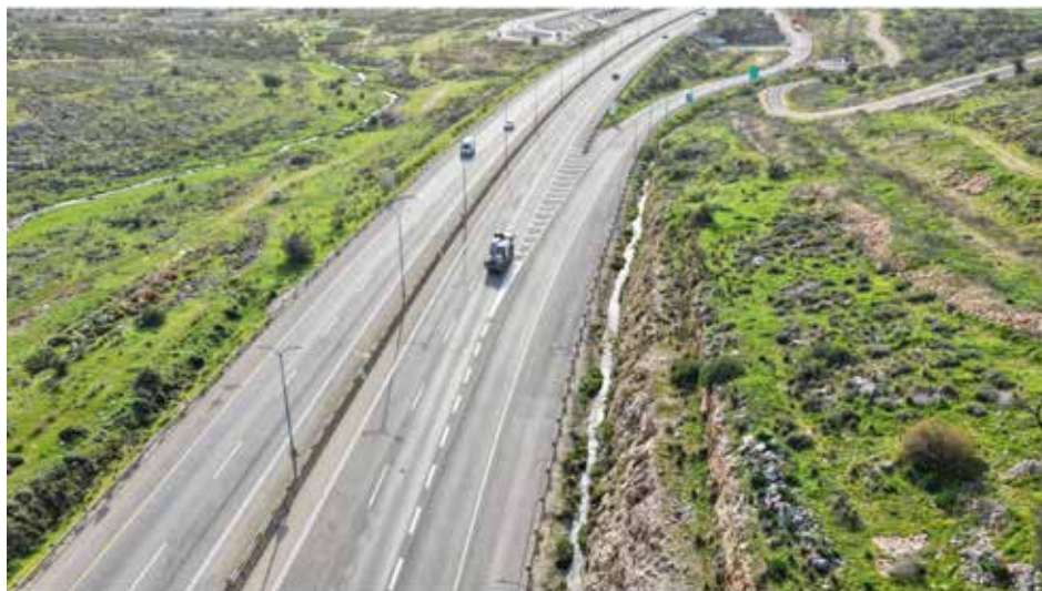
תמונה 16: כביש 5: זרימת מי קולחים ברמה שניונית מאת ברקן (ימין), ושפכים מאת אריאל (שמאל)
